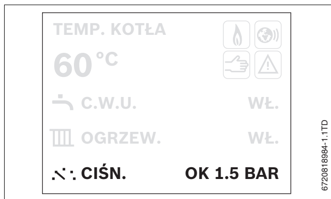
Rys. 5 Odczytanie ciśnienia roboczego
